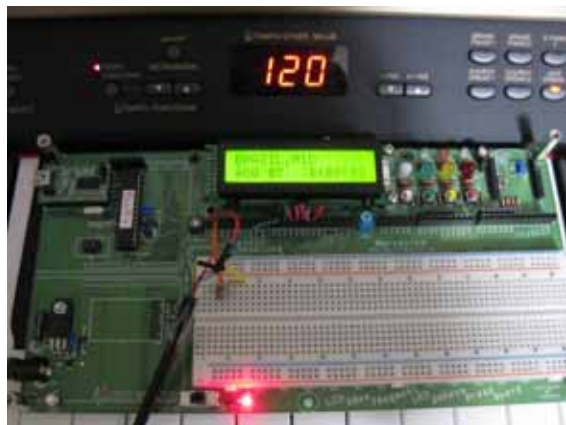
Arduino互換テストボードのMarduinoでMIDI演奏にチャレンジ
